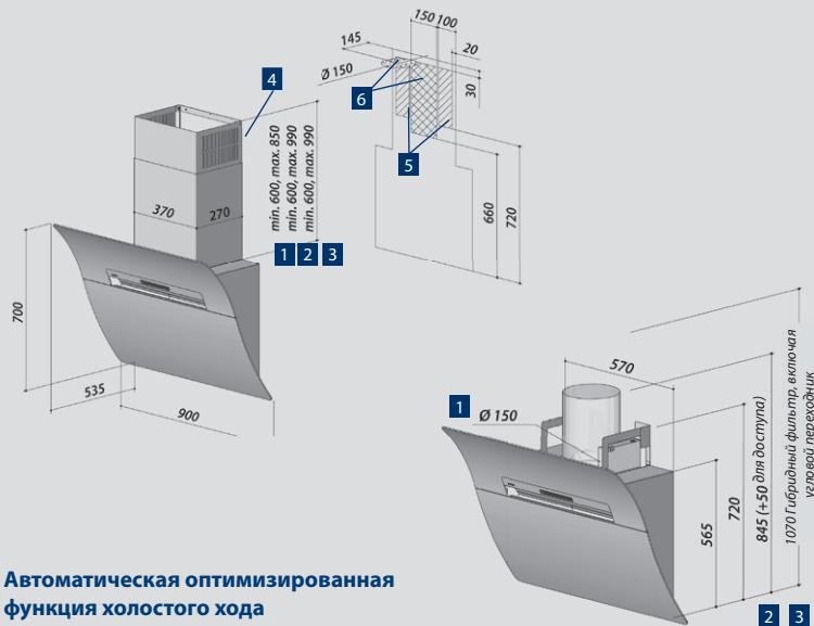
**Автоматическая оптимизированная функция холостого хода****Индикация состояния угольного фильтра: есть****Подключение к воздуховоду Ø150мм****Двигатель мощностью: 750м³/час****Потребляемая мощность двигателя: 195 Вт****LED подсветка и интерьерная подсветка: 16 Вт****Только LED подсветка: 12 Вт****Уровней мощности: 4****Звуковое давление на 3 скорости: 49 дБ****Вес нетто: 28 кг****Рекомендованное расстояние от варочной панели – 25 см для газовой – 65 см**
